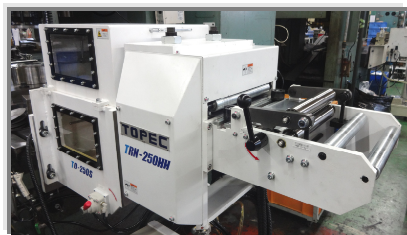
(写真はスプレー式塗油装置が配備されております。※オプション)
